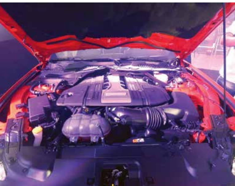
Motor V8 5.0 desenvolve 466 cv e 62,9 kgfm de torque
