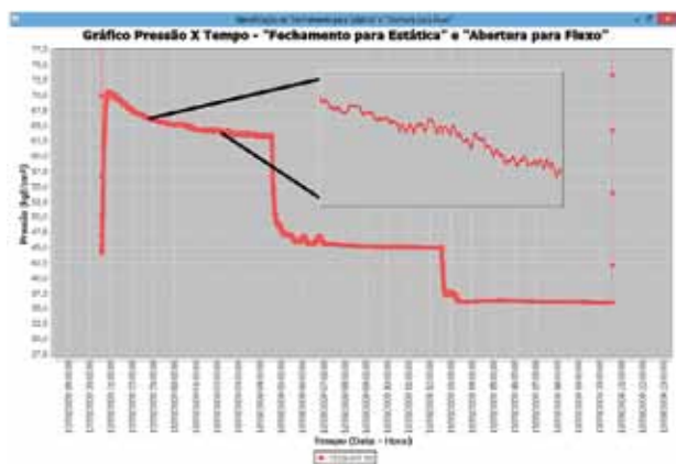
Figura 6 – Abertura para fluxo com detalhes da tendência de pressão decrescente
