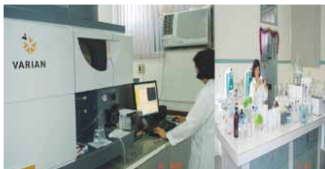
Modernização dos laboratórios do ITPS: Espectrômetro de Emissão Ótica com Plasma Induzido (ICP – OES)
